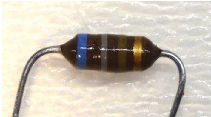
Fotografía de una inductancia de 680 uHy codificada con 4 bandas de colores.
