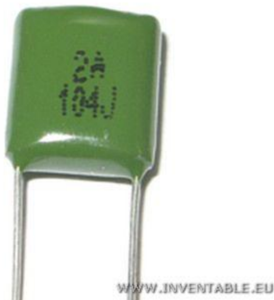
Capacitor de 100nF, +/-5% de tolerancia y 100V de tensión máxima de trabajo
