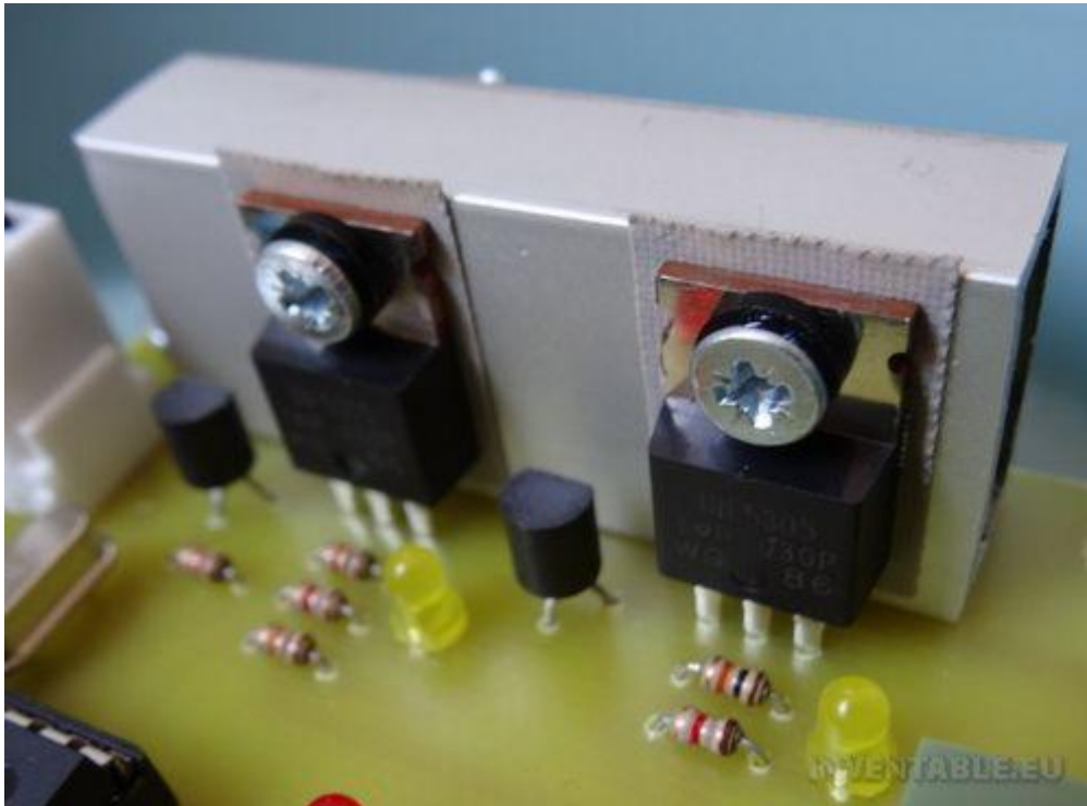
Mosfets con un disipador casero hecho con un perfil de aluminio
