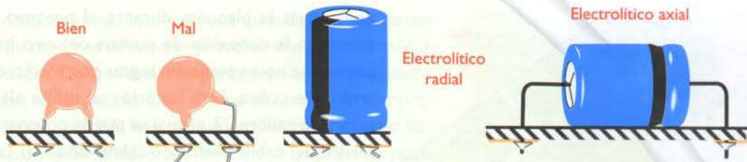
Figura 6.10. Montaje de los condensadores
