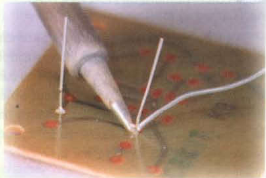
Figura 6.18. Aplicación de la soldadura. El cautín debe permanecer inmóvil
